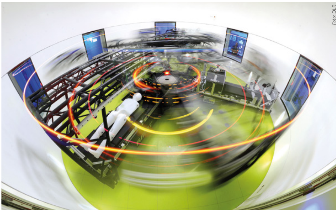
Die neuartige Kurzarm-Humanzentrifuge ermöglicht Bewegungstests während der Rotation.
